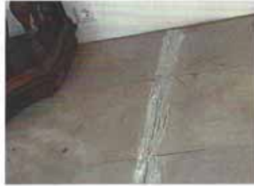
Während der Einwirkzeit verändert der Reiniger Farbe und Konsistenz bis zu einem weißen Pulver bei völliger Austrocknung.
